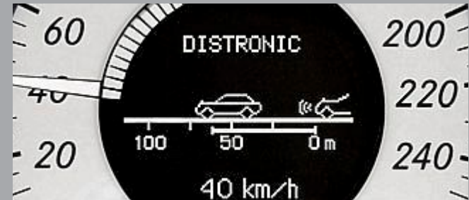
El TEMPOMAT con regulación de distancia DISTRONIC (opcional) muestra los dos vehículos y la separación entre ambos.
