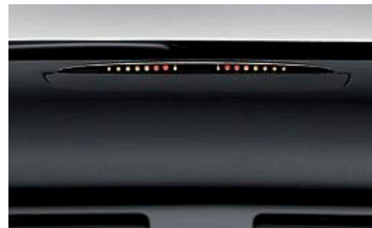
El indicador del sistema PARKTRONIC opcional le muestra cuánto espacio tiene disponible delante y detrás del vehículo para aparcar.
