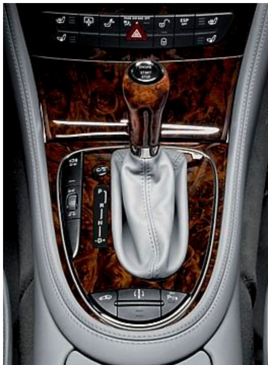
La tecla de arranque y parada del sistema opcional KEYLESS-GO se encuentra en el pomo de la palanca de cambios.
